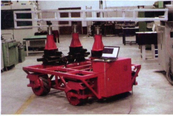
图8 机翼柔性三点支撑实验系统
